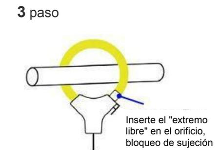
Inserte el "extremo libre" en el orificio, bloqueo de sujeción
