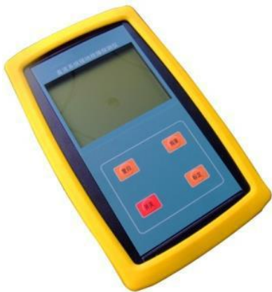
Рис.1DC Локатор замыкания на землю
